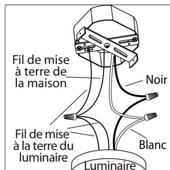
4. Branchez les fils de la mise a terre (cuivre nu ou vert) de votre montage au fil de la mise a terre (cuivre nu ou vert) ou vis de la mise a terre dans la boîte électrique. Posez le fil noir (ou fil ayant un écriteau) de la fixture au fil noir dans la boîte électrique et posez le fil blanc de la fixture au fil blanc dans la boîte.
