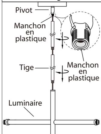
2. Installez la longueur de colonne requise en faisant passer le fil dans la colonne puis en vissant la colonne sur le luminaire. Installez le pivot sur la tige en vous assurant à ce que le manchon de plastique soit au niveau du pivot.
