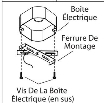
3. Posez la ferrure d'installation à la boîte de sortie électrique à l'aide des vis de la boîte (en sus).
