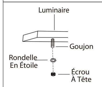
5. Une fois les connexions de fils terminées, insérez soigneusement les fils et les capuchons de connexion dans la boîte électrique en vous assurant qu'il n'y a aucun filament nu (sur le fil blanc et le fil noir) visible au niveau des capuchons de connexion. Posez le luminaire au plafond en alignant le trou (s) du lustre avec les boulons sur la ferrure de montage. Serrez le luminaire en place à l'aide des écrous étoilés et les écrous à capuchon.
