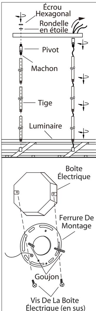
1. Installez la longueur de colonne requise en faisant passer le fil dans la colonne puis en vissant la colonne sur le luminaire. Installez le pivot sur la colonne en vous assurant que le manchon est au niveau du pivot.
