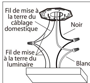
4. Branchez les fils de la mise a terre (cuivre nu ou vert) de votre montage au fil de la mise A terre (cuivre nu ou vert) ou vis de la mise a terre dans la boîte électrique. Posez le fil noir de la fixture au fil noir dans la boîte électrique et posez le fil blanc de la fixture au fil blanc dans la boîte.
